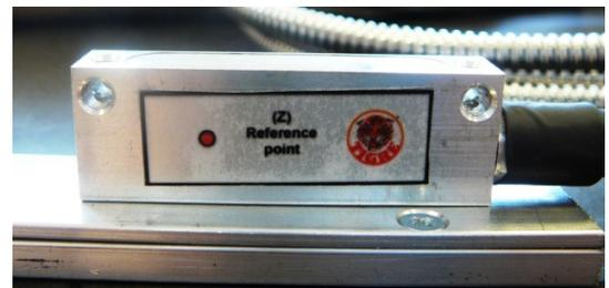
Encoder mit Markierung für den Referenzmagneten
