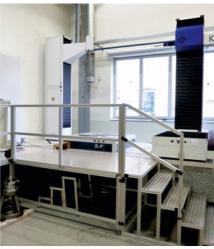
Motorische Positionierung der Messeinheit (V-Achse) auf den aktuellen Werkstückdurchmesser
